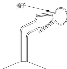
图 7-1 固体进样器
